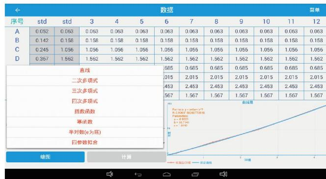
图10、APP数据处理界面，只需选择标曲，确定稀释方式和线性拟合方式，自动生成标准曲线。可一键将样本OD值换算成浓度。
